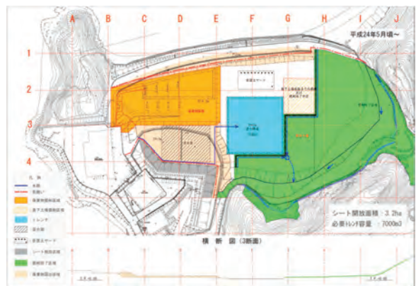
図3-1-2-3-25 第2次掘削計画（見直し後） （平成24年5月頃～）
