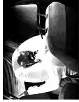
平成10年以前にガス発生剤(アジ化ナトリウム)は人体に有害であり、また展開せずにそのまま破砕機やアルミニウム溶融炉に入ると、爆発する危険性がある。
