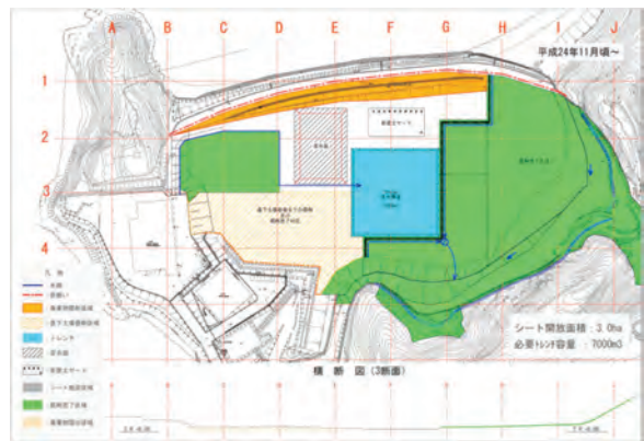
図3-1-2-3-27 第2次掘削計画（見直し後） （平成24年11月頃～）
