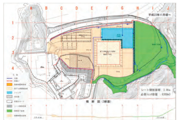
図3-1-2-3-21 第2次掘削計画（見直し後） （平成23年11月頃～）
