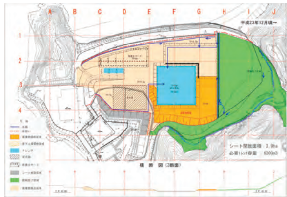
図3-1-2-3-23 第2次掘削計画（見直し後） （平成23年12月頃～）
